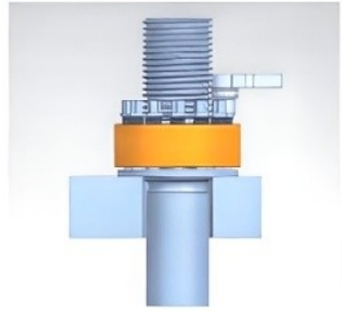
超长螺栓尾部
